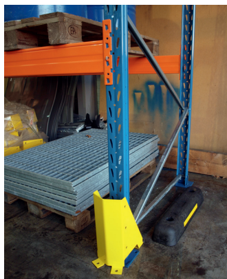
Echelle pré-assemblée avec traverses et diagonales.
